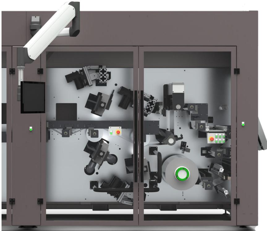
**Abb.1:** Ausschnitt einer PEM Inspektions- und Schneidanlage von Printum Technology.
